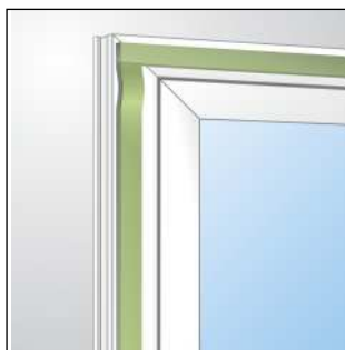
Монтаж ленты на оконной конструкции.
