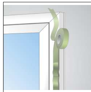
Монтаж стыка при разрыве ленты.
