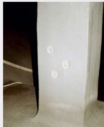
5) Адгезионные испытания готового покрытия. Контроль качества
